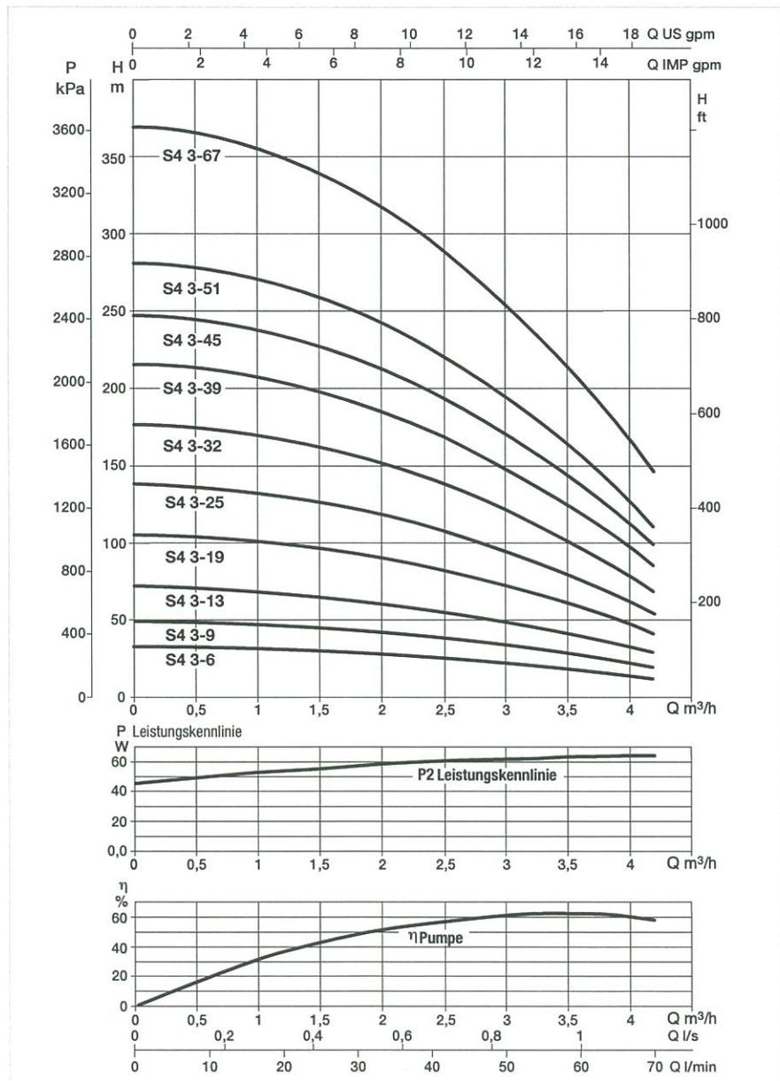
Die Leistungskurven basieren auf kinematischen Viskositätswerten = 1 mm²/s und einer Dichte von 1000 kg/m³. Kurventoleranz nach ISO 9906.
