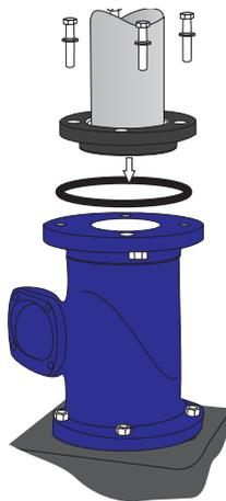
6. ▷ Flanschdichtung DN 100 auf den Anschlussflansch des Kugelrückschlagventils auflegen.
